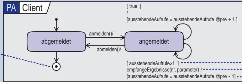
Die Zustandsübergänge von Protokoll-Zustandsautomaten verfügen über eine **Vorbedingung**, einen **Auslöser** und eine **Nachbedingung** (alle optional) – jedoch nicht über einen Effekt.
